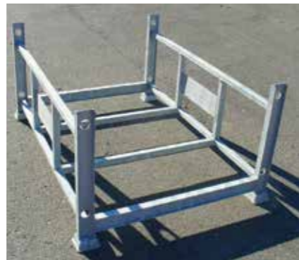
Los palés abiertos facilitan el almacenamiento de componentes de mayores dimensiones.
